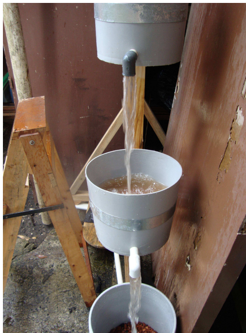
Figura 11 Aireación del agua con \text{Fe}^{+2} y \text{Mn}^{+2} en contacto con piedra pómez.
