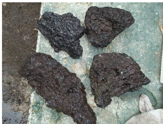
Figura 9 Piedra volcánica decolorada al ser utilizada en el proceso de aireación
