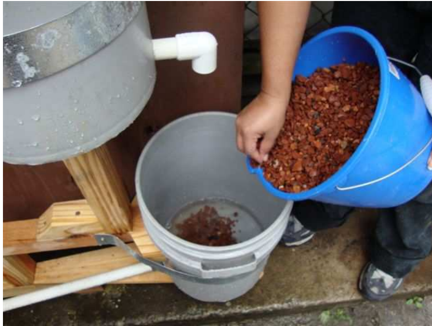
Figura 10 Aireación del agua con \text{Fe}^{+2} y \text{Mn}^{+2} en contacto con arcilla
