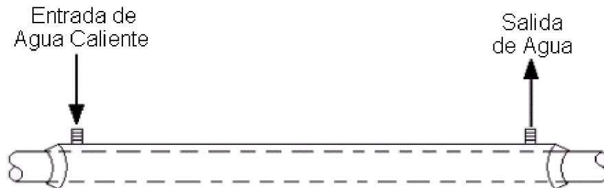
Figura 4. Tubería de Conducción
