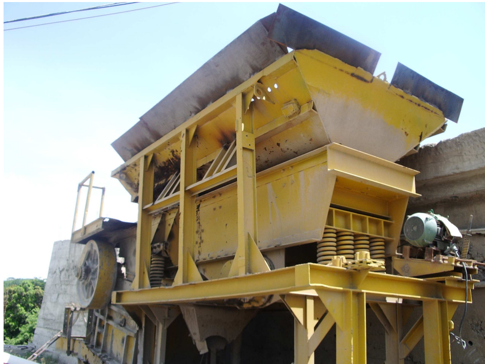
Figura 15. Tolva alimentadora vibrátil
