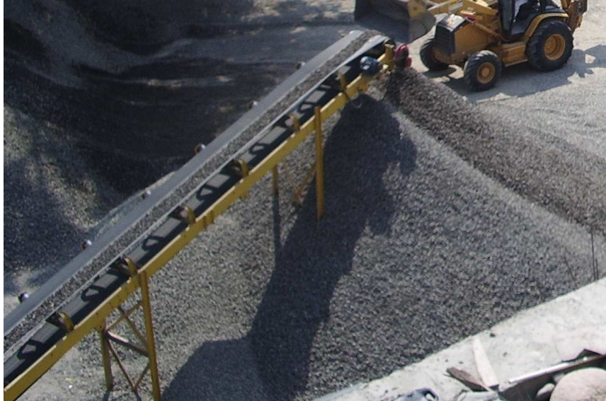
Figura 32. Transportador de producto terminado
