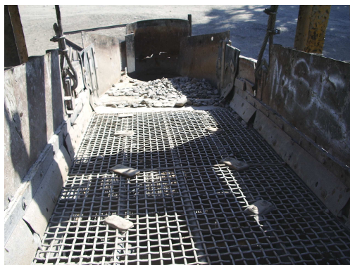
Figura 45. Cribado secundario de material
