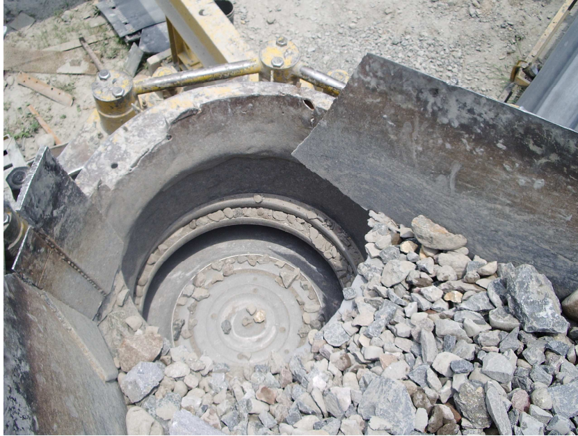
Figura 27. Parte superior de tolva receptora de material
