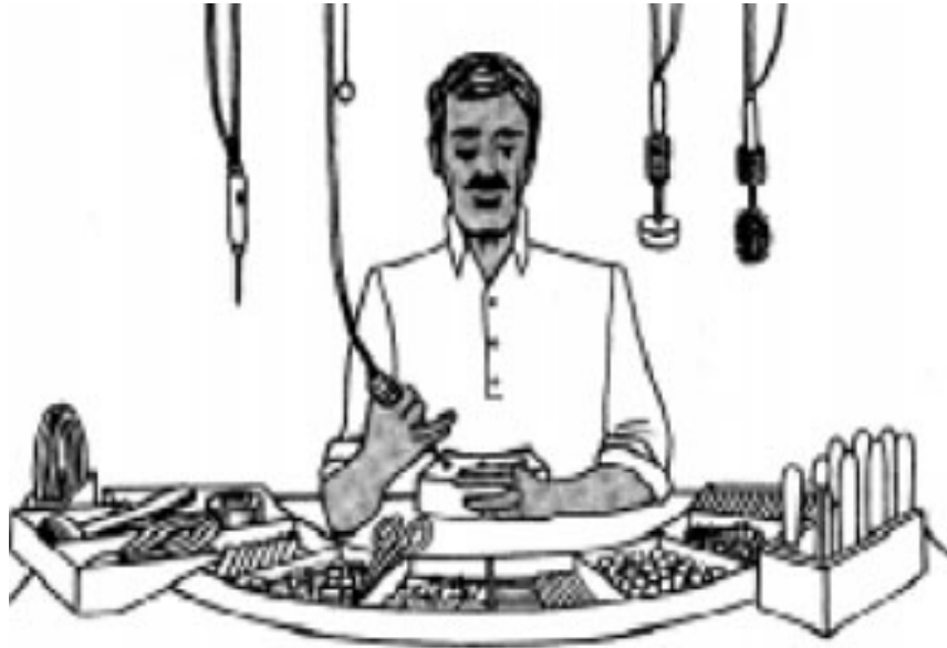
Figura 33. Colocación de herramienta neumática fija 28
