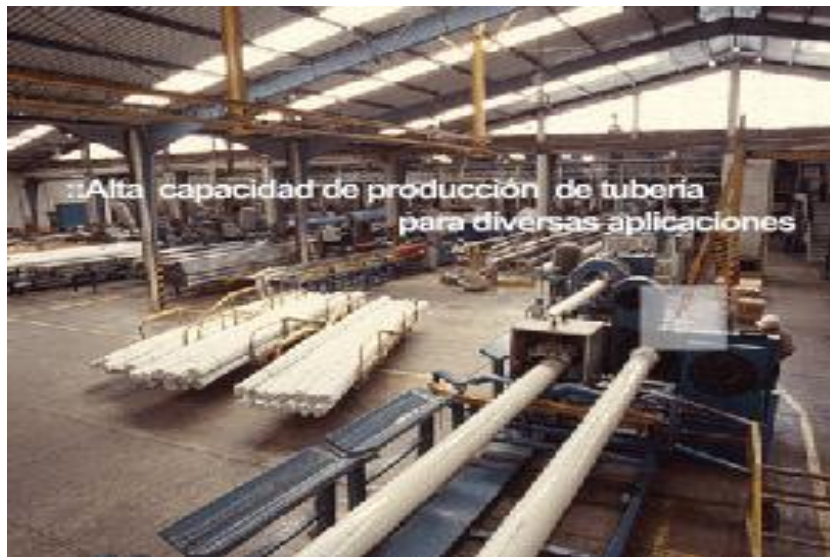
Figura 39. Planta de fabricación de tubos de PVC.
