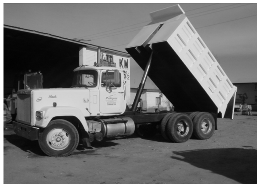
Figura 9. Camión de volteo
