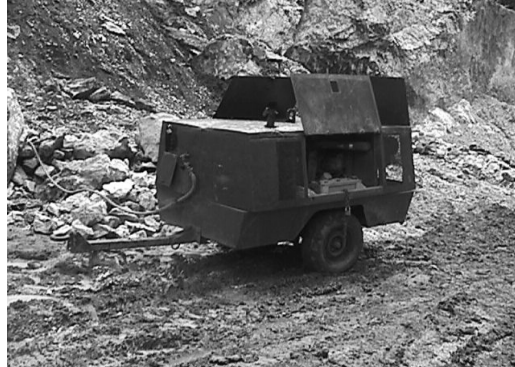
Figura 8. Compresor de tornillo rotativo
