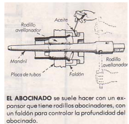
Figura 50. Abocinado de tubos
