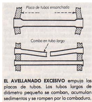
Figura 54. Combadura por el exceso de avellanado.
