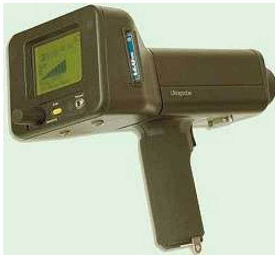
Figura 15. Equipo para realizar inspecciones ultrasónicas
