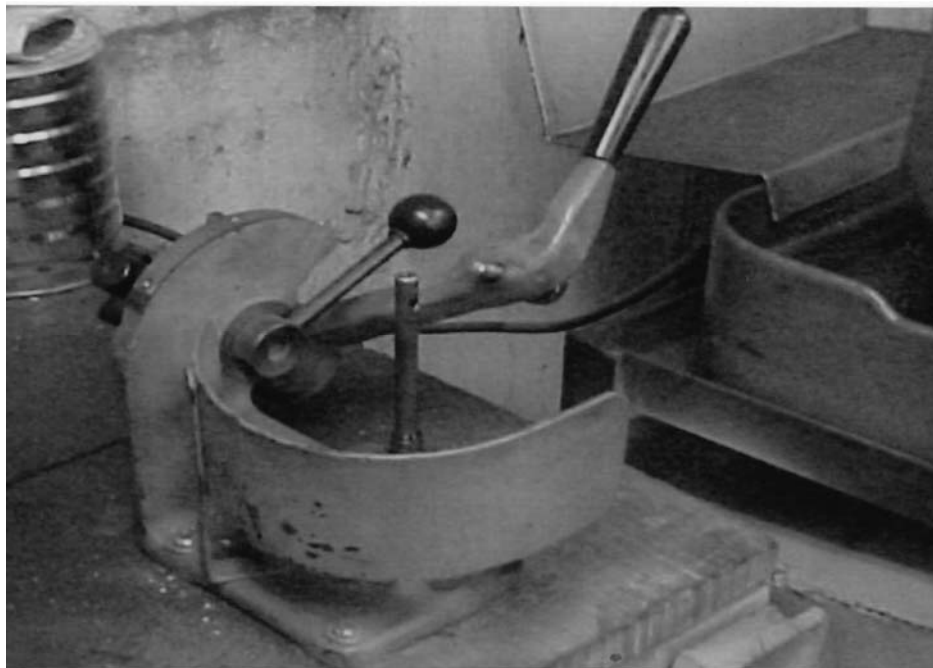
Figura 21. Máquina para reacondicionar herramientas de fresado de asientos de válvulas
