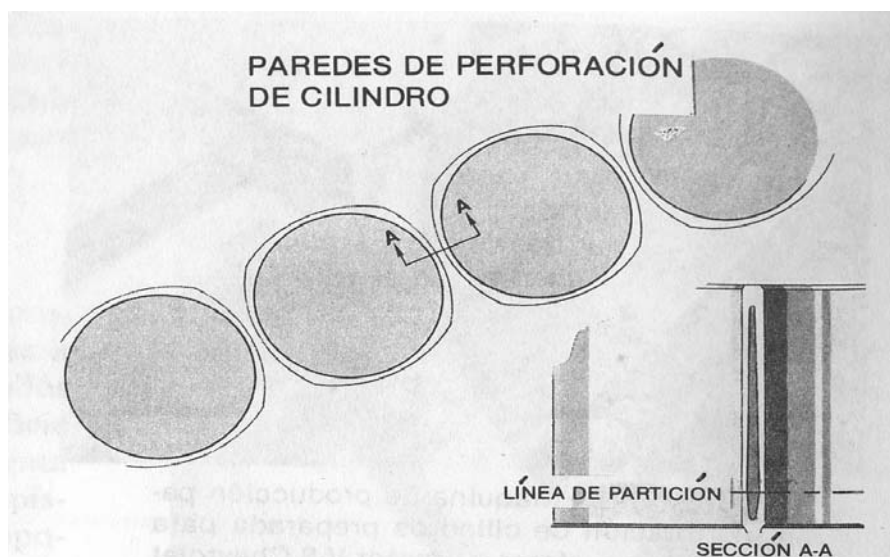
Figura 47. Prueba ultrasónica para determinar el espesor de la pared del bloque de cilindros
