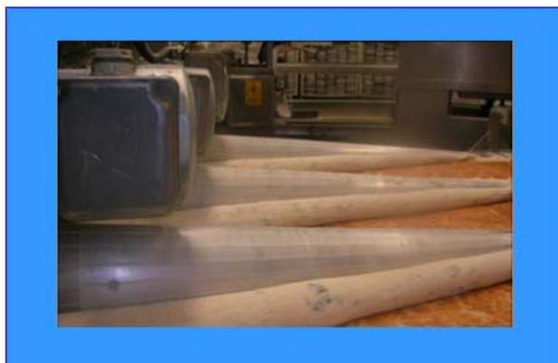
La separación entre cada rodillo enrollador tiene relación con el ancho de cada paño dividido por las cuchillas, teniendo las siguientes medidas dadas por especificación:
