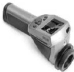
Figura 15. A) Cámara para análisis termográfico. B) Imagen Termográfica e Imagen real tomadas de unos fusibles.
