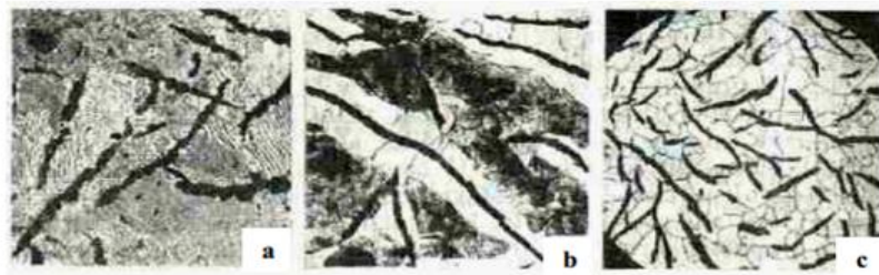
Figura 1.1. Microestructura de la fundición gris: a) fundición perlítica, tomada a 200 aumentos; b) fundición ferrito - perlítica, tomada a 100 aumentos; c) fundición ferrítica, tomada a 100 aumentos 1 .
