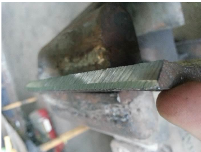
Figura 21. Biselado de probeta
