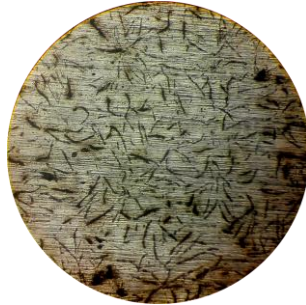
Figura 16. Micrografía del metal base, fundición gris, aumento de 100X.
