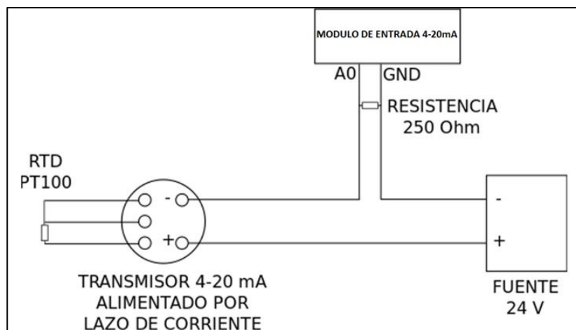
Figura 29. Diagrama de conexión RTD – transmisor a PLC
