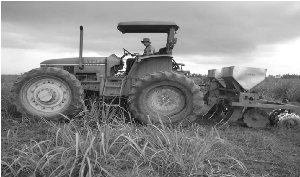
Figura 56. Combinación del conjunto Tractor-Abonocultivadora para efectuar pruebas de campo con dinamómetro hidráulico acoplado entre el tractor y el implemento
