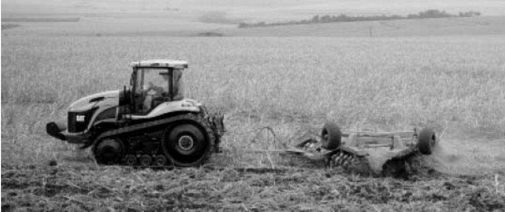
Figura 9. Combinación Tractor- Rastra rompedora
