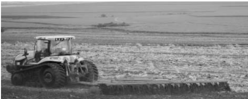
Figura 10. Combinación Tractor- Rastra pulidora
