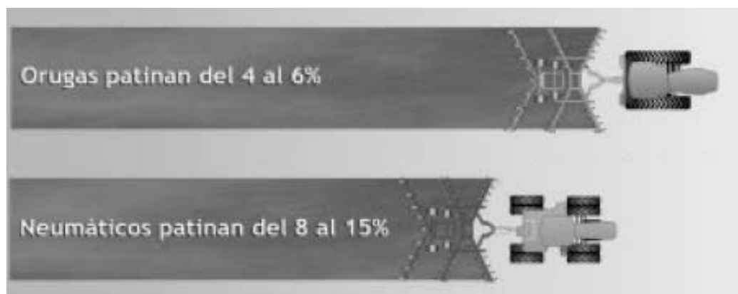
Figura 43. Tractores de oruga patinan menos que los tractores de neumáticos
