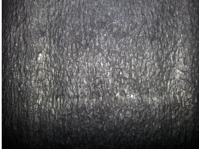
Figura 32. Superficie laminada con calibre o pase quemado
