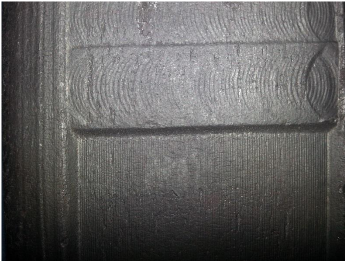
Figura 31. Superficie laminada con calibre o pase nuevo
