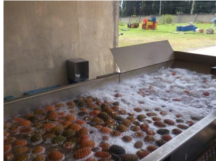
Figura 11. Pila de lavado
