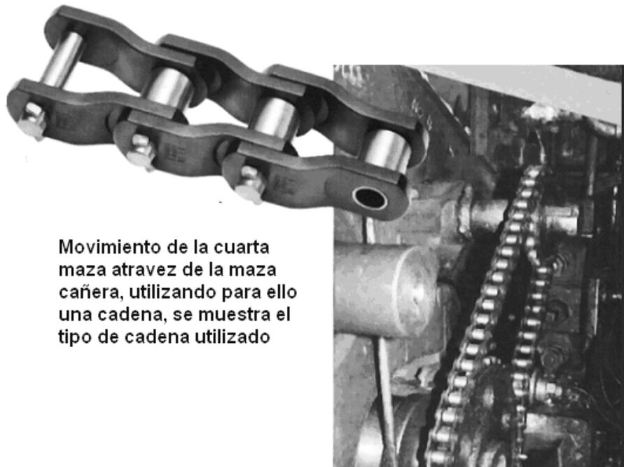
Movimiento de la cuarta maza a través de la maza cañera, utilizando para ello una cadena, se muestra el tipo de cadena utilizado
