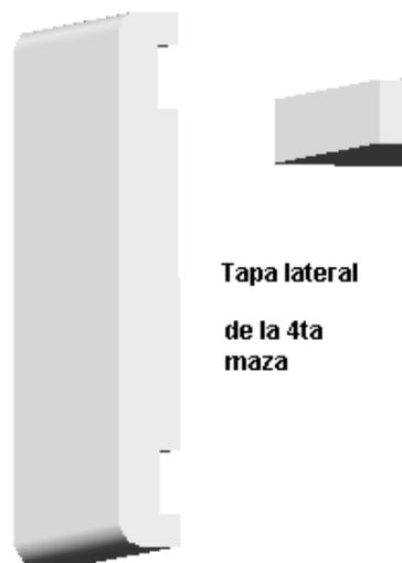
**Figura 106. Conjunto de las piezas que sostienen la cuarta maza en el molino uno Farrel**
