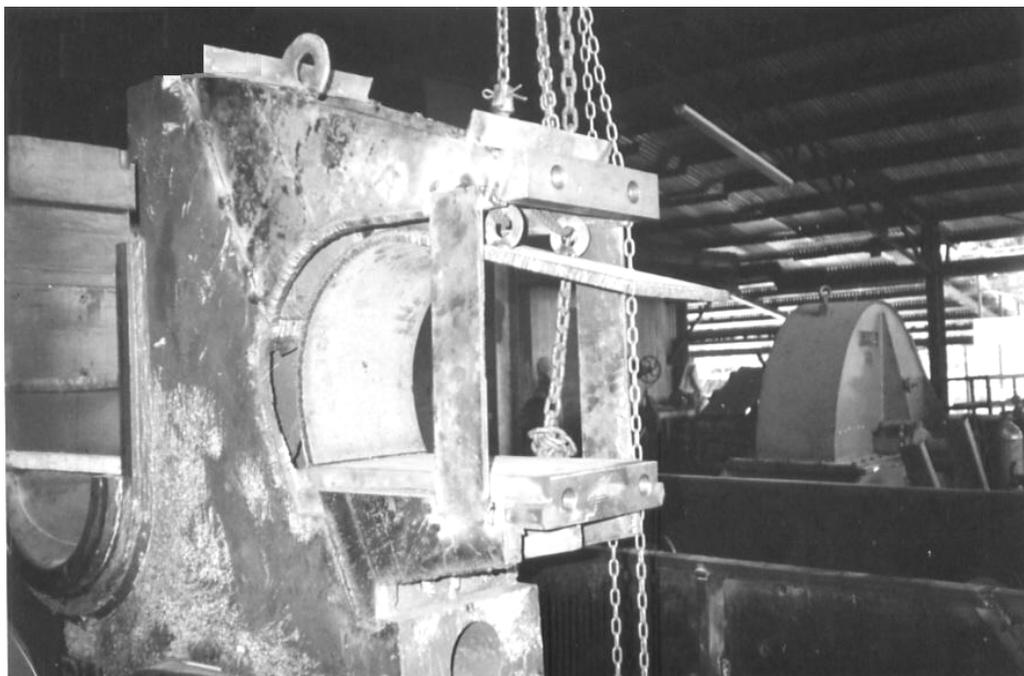
**Figura 141. Corte de la virgen molino dos con cartagones colocados**
