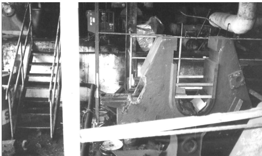
**Figura 142. Colocación de la virgen del molino dos en su lugar con su base terminada**
