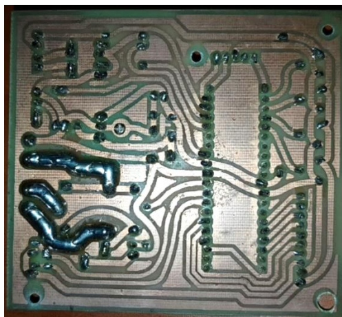
Figura 58. Soldadura de PCB
