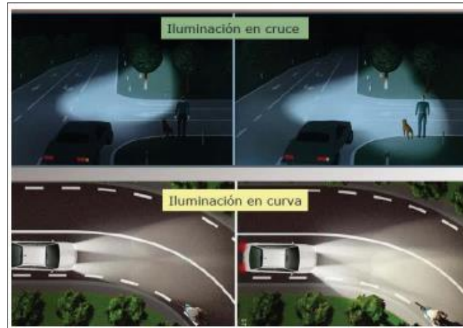
Figura 36. Sistema de iluminación orientable
