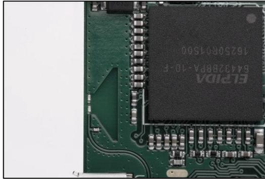
Fuente: *Antena y capacitores para Wireless dentro de Raspberry Pi Zero W*. <https://www.raspberrypi.org/magpi/pi-zero-w-wireless-antenna-design/>. Consulta: 4 de enero de 2018.
