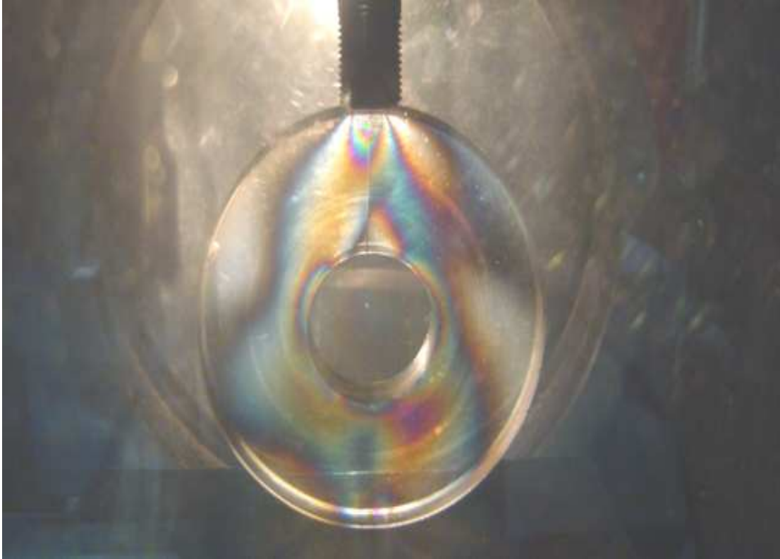
Figura 31. Ensayo a compresión con una carga de 230 psi.
