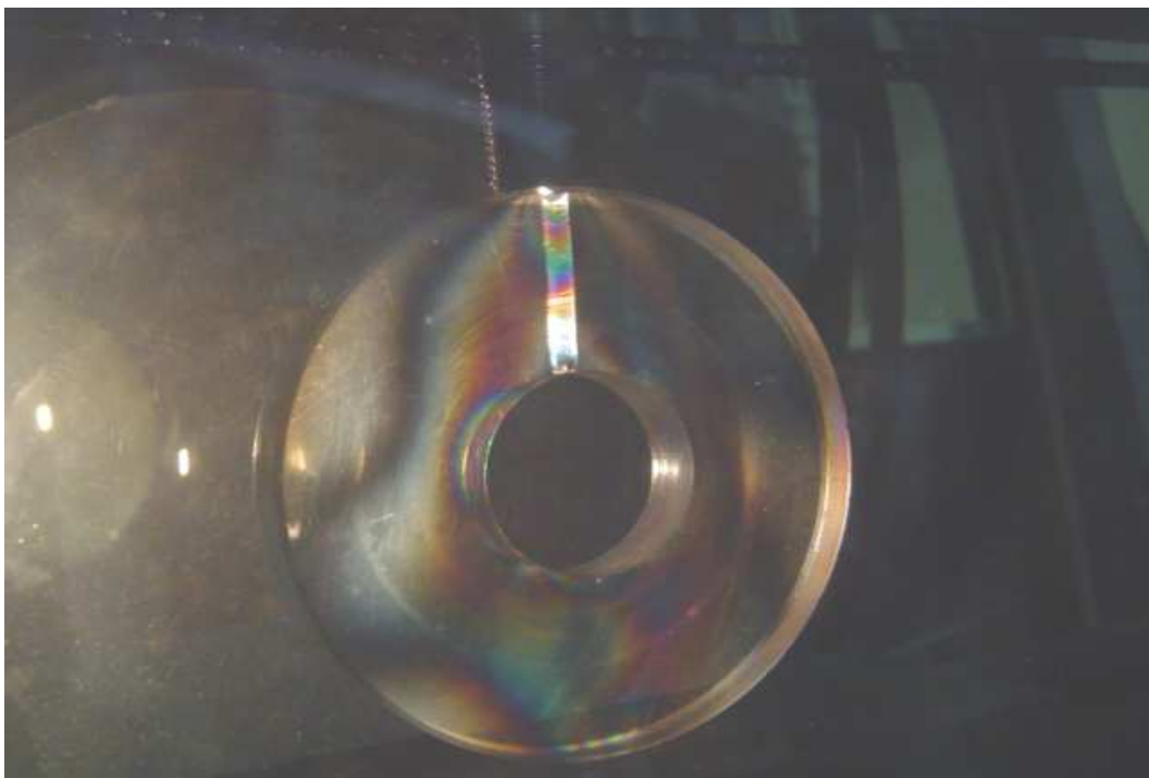
Figura 32 Falla de la probeta a compresión a 310 psi.
