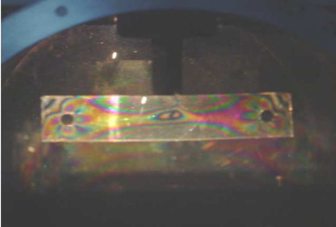
Figura 36 Prueba a deflexión a 75 psi.
