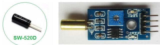
Fuente: *Sensor SW-520D en módulo*. <http://www.electroschematics.com/12124/arduino-tilt-sensor-experiment/>. Consulta: enero de 2017.
