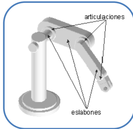
Figura 10. Elementos estructurales de un brazo robótico
