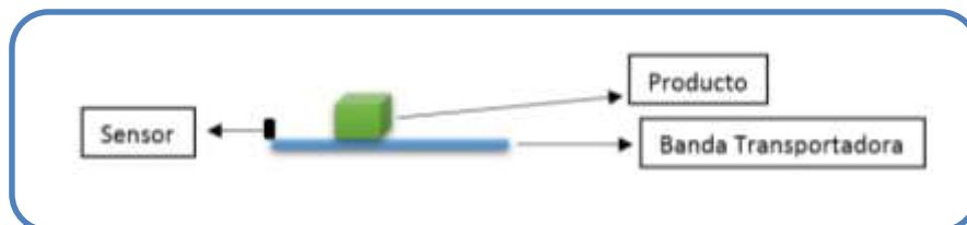
Figura 47. Disposición del sensor de proximidad
