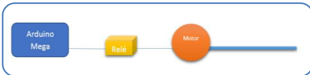
Figura 26. Disposición general de los elementos del sistema de control de la línea de producción
