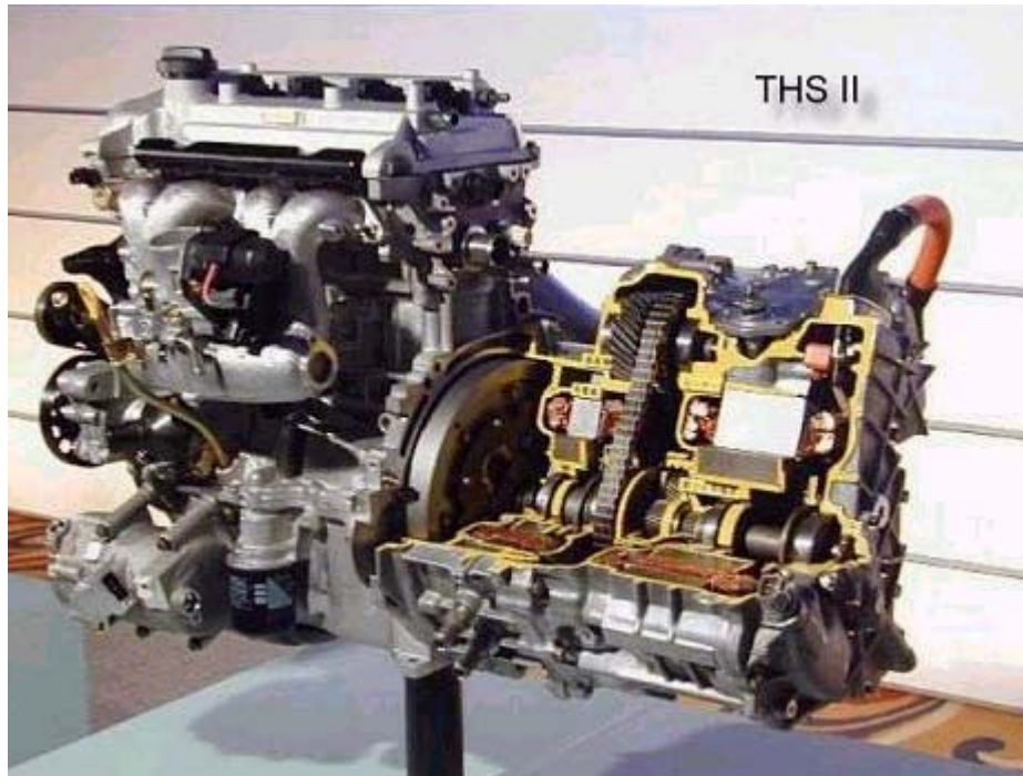
Figura 12. Corte en la transmisión del Toyota Prius. Nótese como el motor/transmisión forma parte de esta.
