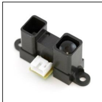
Figura 2. Sensor de distancia infrarrojo Sharp GP2Y0A02YK0F
