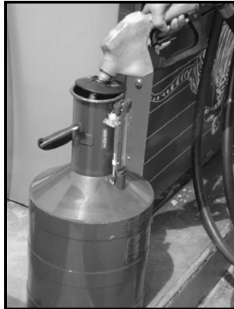
Figura 22. Medidor volumétrico fiscalización técnica
