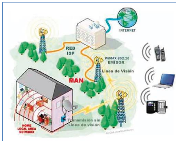
Figura 6. Diagrama de una red WiMax
