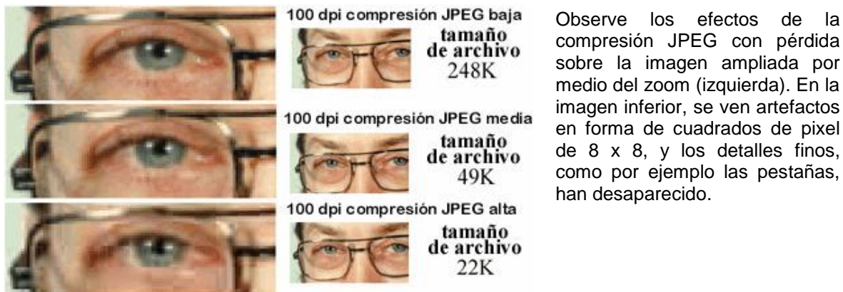
Figura 7. Compresión con pérdida
