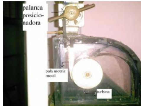
Figura 19. Componentes de turbina Michell Banki
