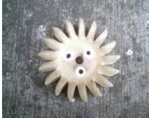
Figura 9. Rodete con cucharas turbina Pelton
