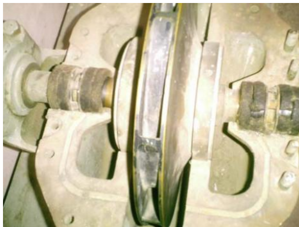
Figura 28. Impulsores, cojinetes y estopas de bomba centrífuga
