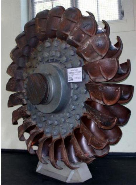
Figura 34 Rodete y alabes de turbina pelton. wikipedia®
