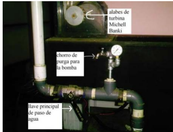
Figura 23. Banco de trabajo de turbina Michell Banki
