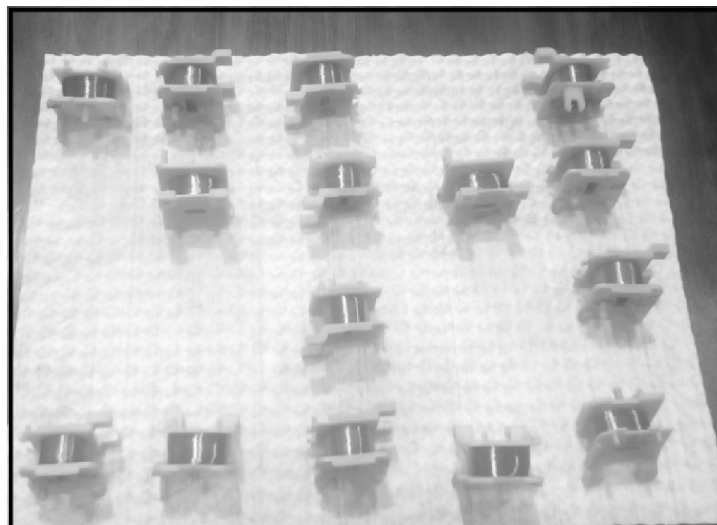
Figura 24. Bobinas de las fotoceldas trabajadas por sensor fotoresistivo- electromagnético
