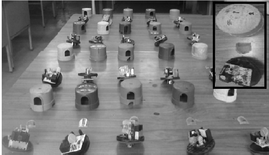
Figura 19. Separación primaria para las fotoceldas. Cubierta, visor y base
