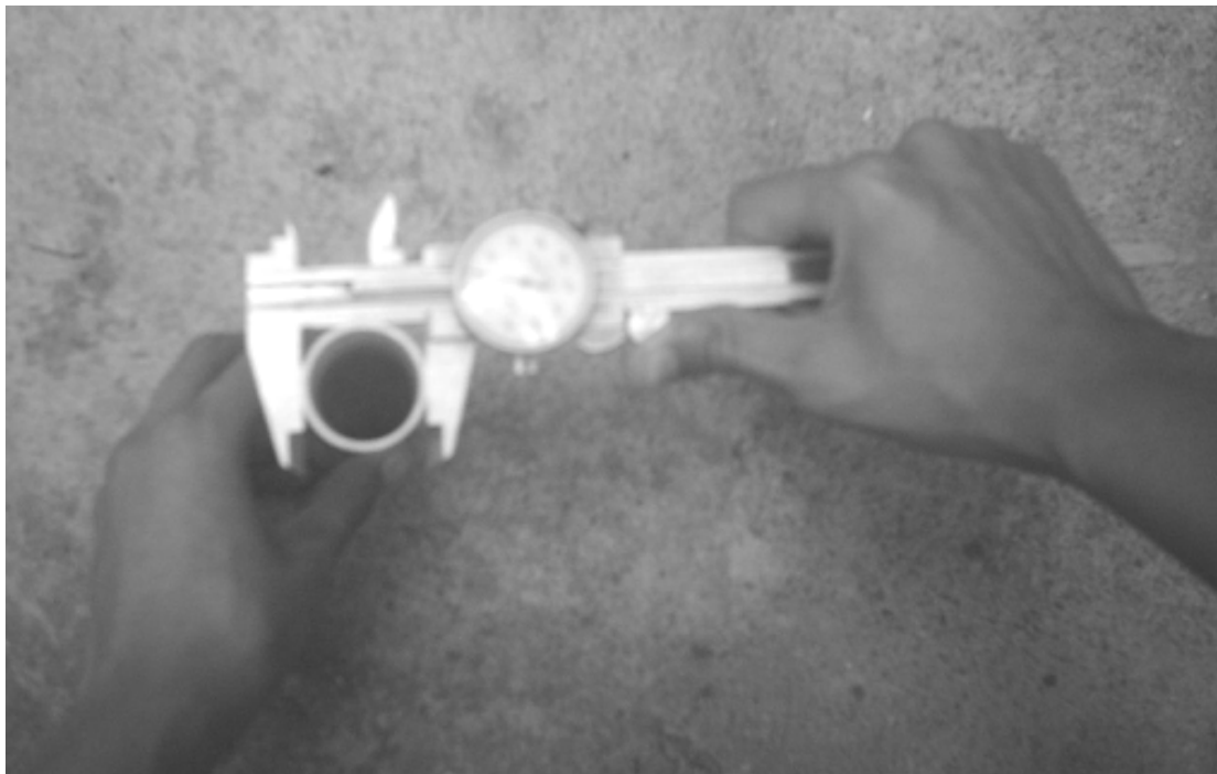
Figura 34. Uso del vernier para obtener la ovalación en la tubería
