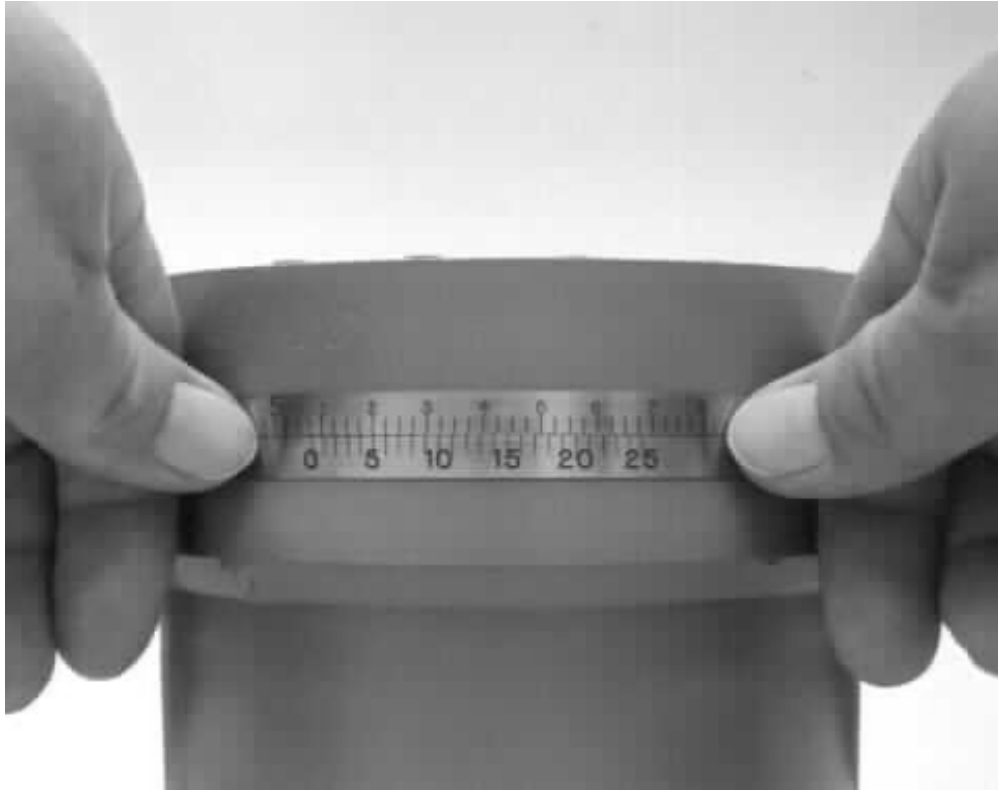
Figura 32. Forma de utilizar la cinta pi-tape
