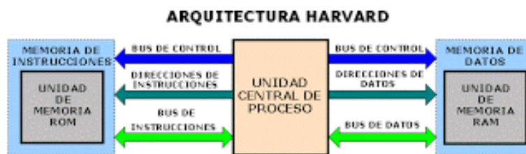
Figura 11. Esquema de la arquitectura Harvard
