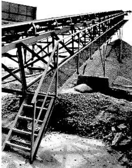
El cuerpo de la cinta transportadora debe quedar a media altura respecto al piso de la pasarela o plataforma de visita, a fin de que se pueda realizar con comodidad la inspección y mantenimiento de los rodillos que soportan el ramal de retorno de la banda. La separación existente entre el piso de la pasarela o de la plataforma y el cuerpo de la cinta debe ser protegido mediante barandilla o paneles resistentes que eviten la posible caída de personas por dicha parte interior.
