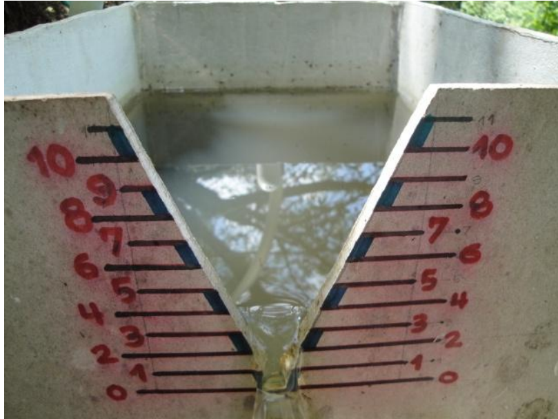
Figura 17. Vertedero utilizado para regular el flujo a la entrada del filtro
