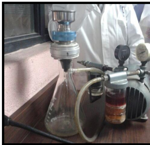
Figura 12 Equipo de filtración
