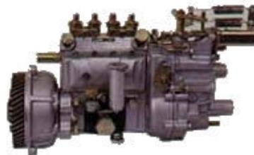
➤ **Colector de la bomba de inyección**
