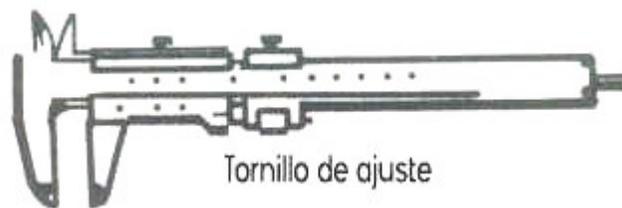
Este tipo está equipado con un tornillo de ajuste el cual se utiliza para mover el cursor lentamente cuando se usa como un calibrador fijo, este tipo permite el ajuste fácil del cursor.
