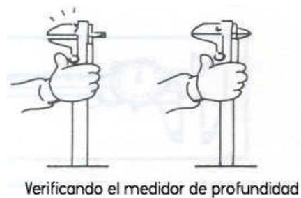
Ajuste el calibrador correctamente sobre el objeto medido.
