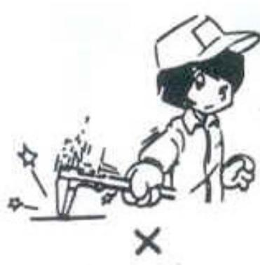
No utilice el calibrador para medir algún objeto en movimiento.
