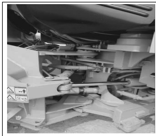
Figura 13. Enganche entre placas del bastidor de un cargador 950H
