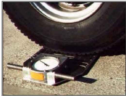
Báscula móvil sin palets de nivelación
