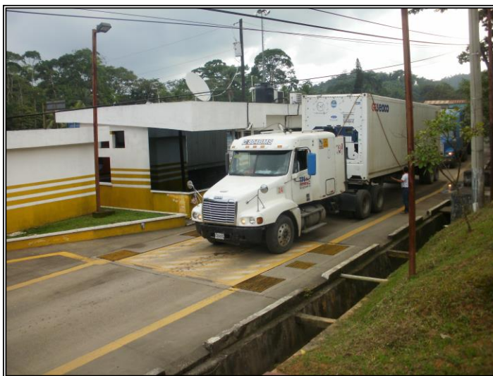
Figura 36. Sistema de pesaje electrónico, plataforma para pesaje por eje
