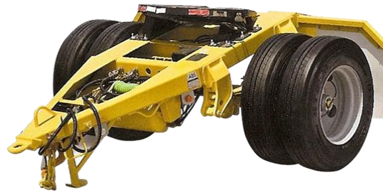
Dolly tipo "A", punta de lanza corta
