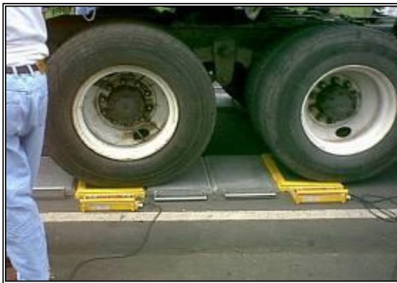
Báscula móvil con palets de nivelación
