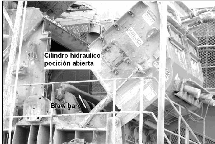
3. Asegurar el rotor en la posición deseada con los seguros proporcionados por fábrica. El rotor debe ser asegurado en ambos lados de la trituradora para prevenir que rote mientras se hacen los trabajos de mantenimiento. Los seguros del rotor extienden a través de la pared lateral del impactador hasta el *blow bar*.
