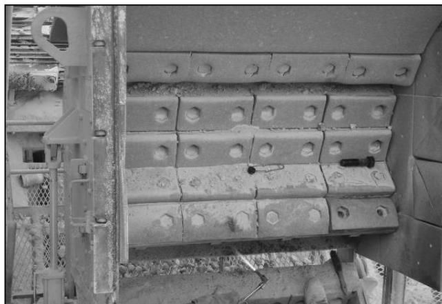
7. Cerrar la cubierta del impactador, usando el sistema hidráulico. Colocar los pernos de la cubierta en posición y asegurarlos.
