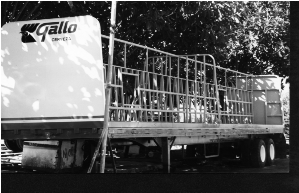
Figura 2. Plataforma de 13.72 mts. de longitud con carrocería
