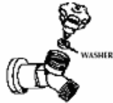
Figura 7 Puntos de posibles fugas de agua en un calentador eléctrico
