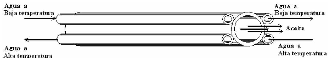
Figura 23 Sección de tubería principal de transportación
