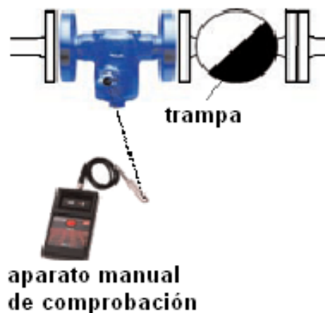
Figura 24. Sensor instalado en línea de vapor para su comprobación
