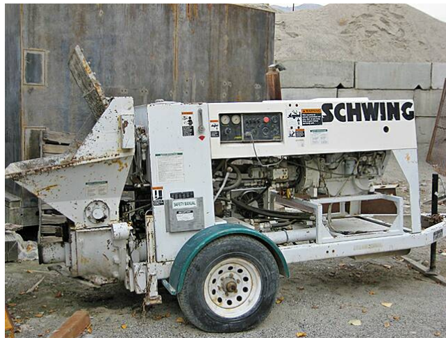
Figura 2. Bomba Impulsadora de concreto marca SCHWING
