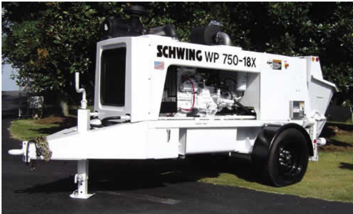
Figura 16. Bomba impulsadora de concreto Schwing
