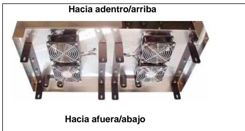
Figura 44. Ventiladores de selladora de tapón
