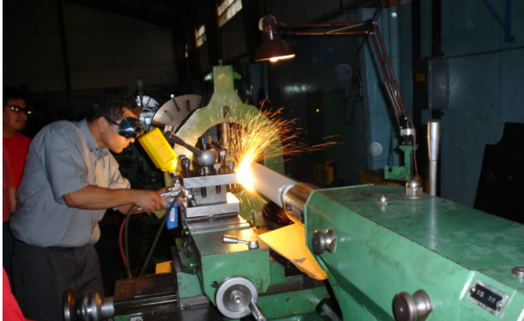
Figura 43. Aplicación de termorociado en frío a un eje
