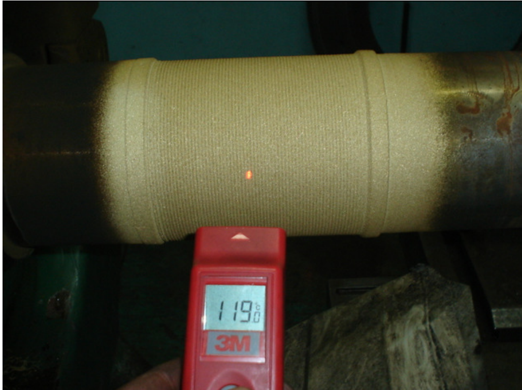
Figura 50. Acabado final de termorociado en frío utilizando aleación de bronce
