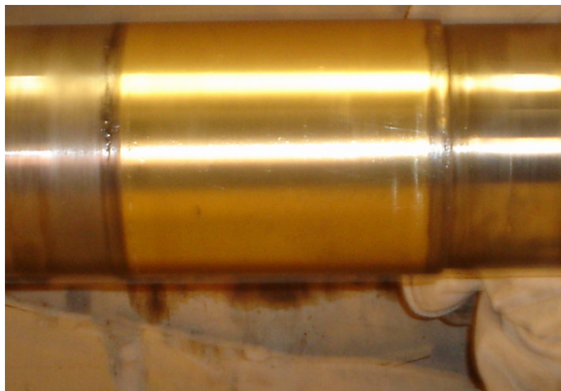
Figura 50. Acabado final de termorociado en frío utilizando aleación de bronce
