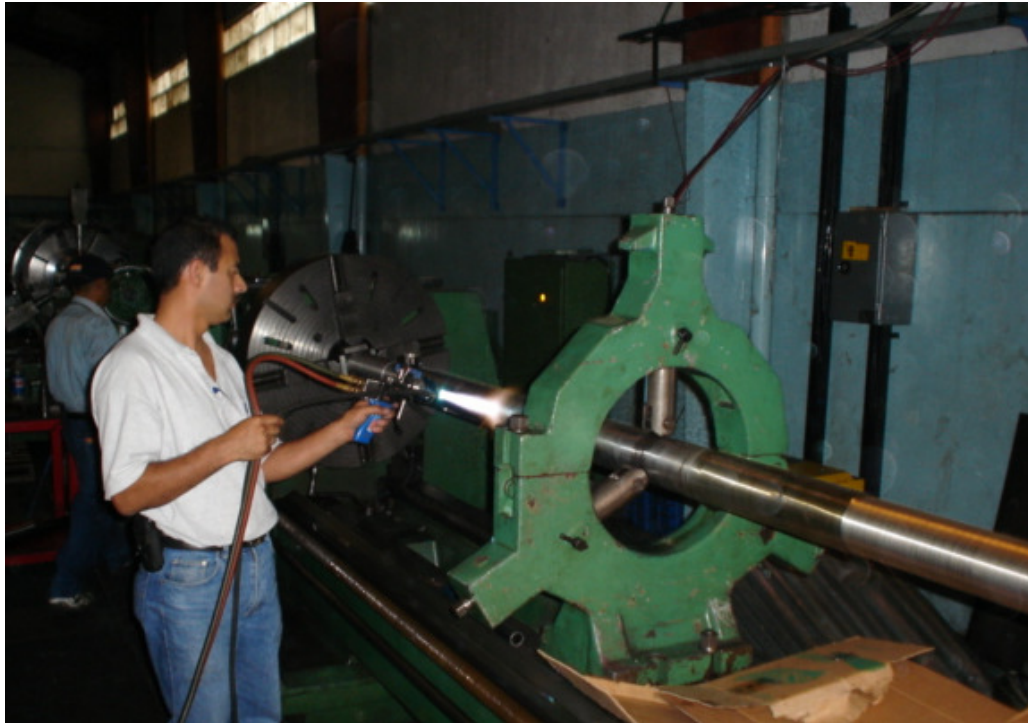
Figura 42. Pre calentamiento de la pieza, antes del termorociado
