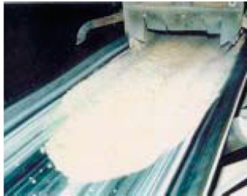
Figura 3. Transporte de arena por medio de fajas de hule
