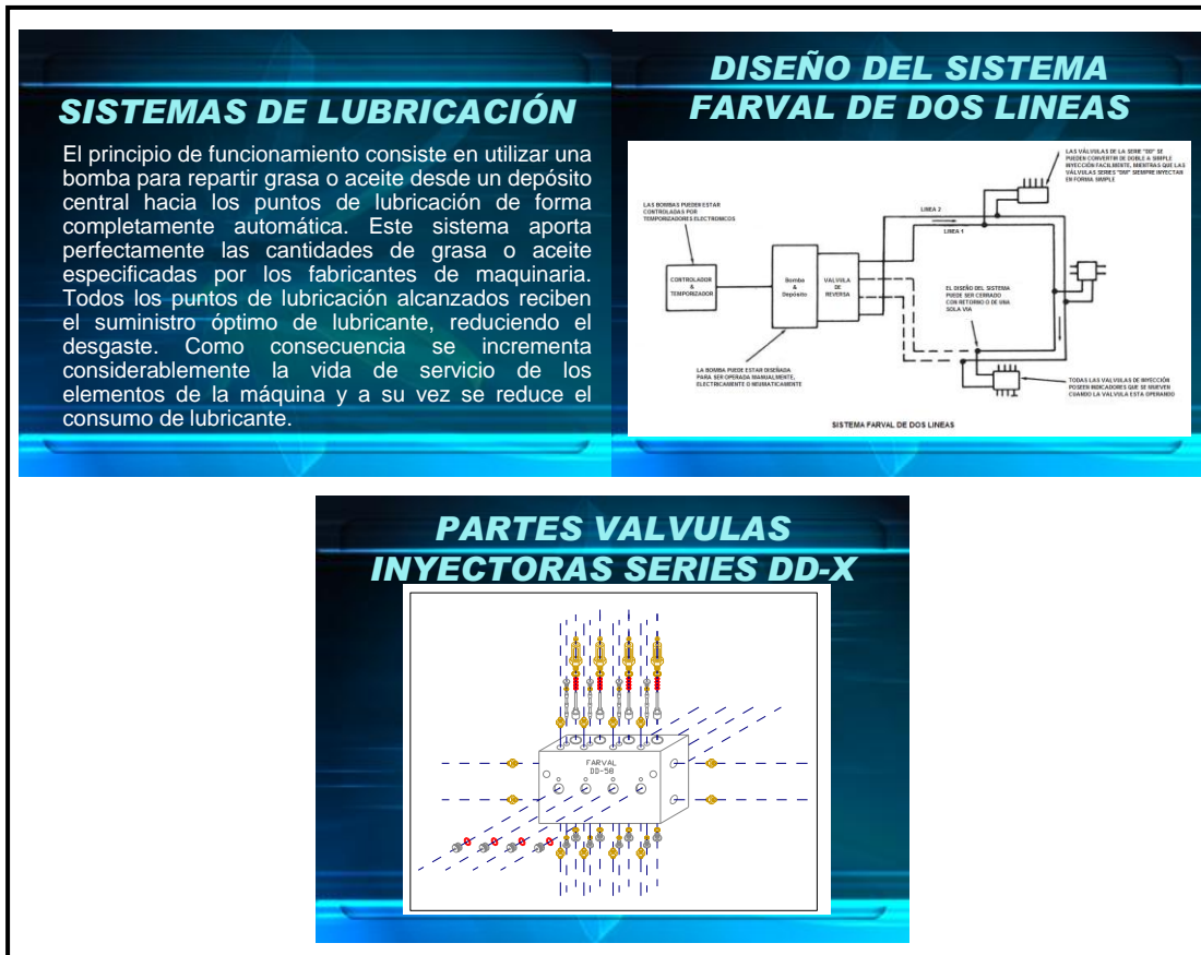
Figura 56. Sistemas de lubricación de chumaceras Farval y Lincoln
