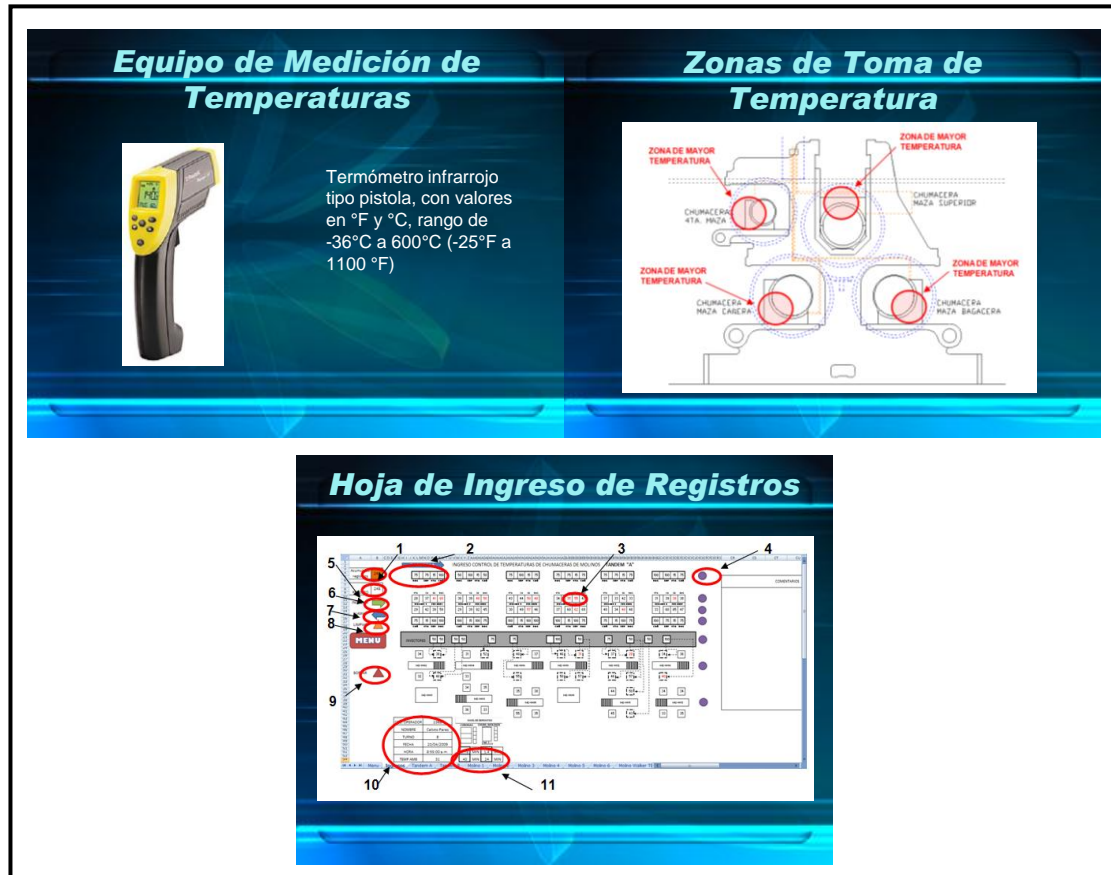
Figura 55. Sistema de Control de temperatura de chumaceras
