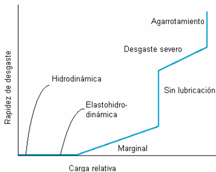
Figura No. 33 Rapidez de desgaste para varios regímenes de lubricación.
