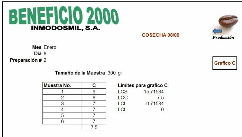
Figura 79. Gráfico de control para defectos por muestra
