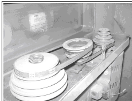
Figura 28. Fajas de taladros de pedestal
