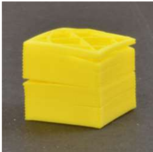
Figura 45. Separación y división de capas
