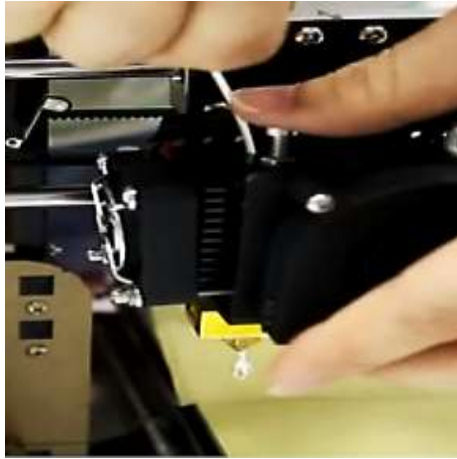
Figura 35. Instalación de filamento
