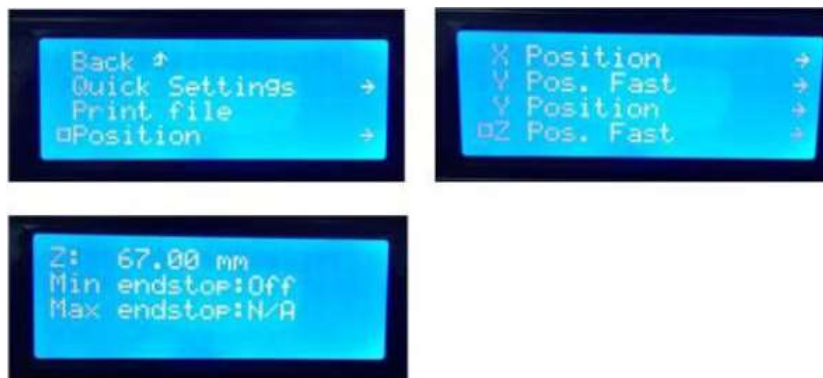
Figura 36. Nivelación de base I
